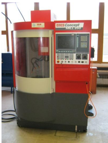
CNC глодалица Concept MILL 250
