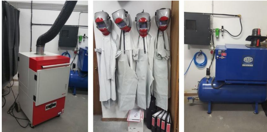
Мобилна одсисна јединица, заштитна опрема, компресор
